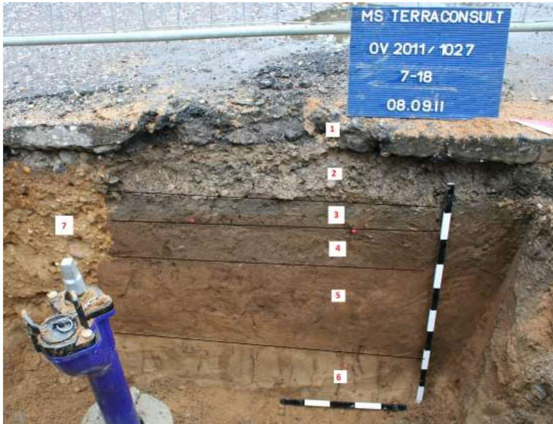
**Abb. 20:** Profil gg. W, Stelle 7 in der Münzstraße: 1 = Asphaltdecke; 2 = Kiese/Sande; 3 = leicht sandiger Ton mit HK-Flitter und etwas Ziegelgrus; 4 = leicht sandiger, etwas lehmiger Schluff mit wenig HK und Ziegelgrus; 5 = lehmiger Schluff, ev. Bt-Rest; 6 = Löss (C-Horizont); 7 = Sand/Kies Verfüllung, moderner Bodeneingriff
